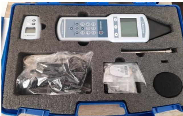
Слика бр.1; Инструмент за определување на ниво на Бучава Sound level meter: Delta Ohm, type HD2010PNE2
