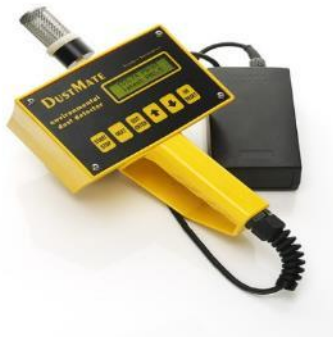
Слика бр.4; Инструмент за мерење на ниво на Квалитет на воздух - определување на вкупни суспендирани честици, респирабилни честици и фракција на ПМ 10 и ПМ 2.5 честици - тип TURNKEY DustMate kit
