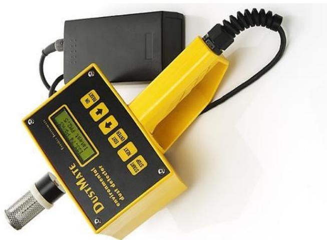
Слика бр.1; Инструмент за мерење на ниво на Квалитет на воздух - определување на вкупни суспендирани честичи, респирабилни честичи и фракција на ПМ 10 и ПМ 2.5 честичи - тип **TURNKEY DustMate kit**
