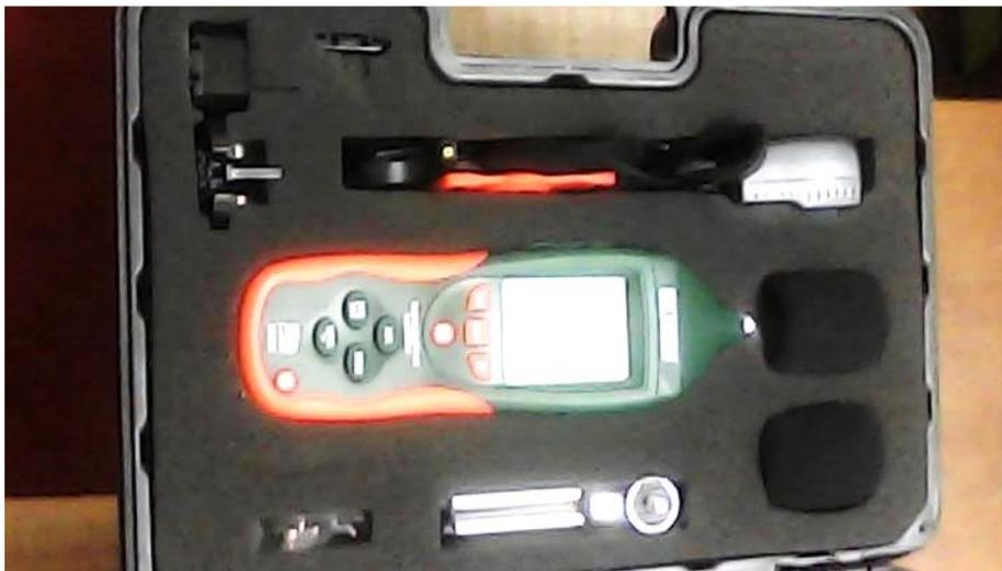
Слика бр.1; Инструмент за определување на ниво на Бучава
